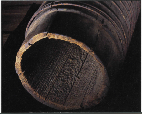
木製水道管も使われた。鉄線で巻かれ、内側はさざくれている。
