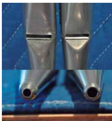
上：歌口 下：空気穴 写真左がメンテナンス後のパイプ
